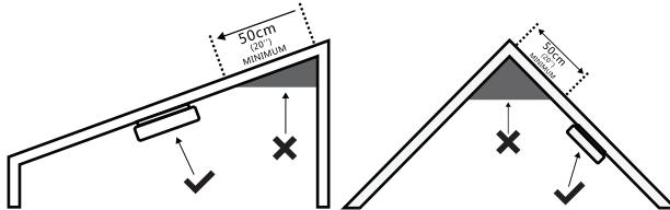
**Merk!** Hvis den ikke kan monteres i taket, kan røykvarsleren monteres på vegg, ca. 15 cm fra taket. Veggmontering kan medføre at det tar lenger tid før røykvarslerens alarm utløses.
