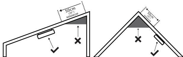
**Notera!** Om det inte går att montera i tak, kan brandvarnaren monteras på vägg, cirka 15 cm från taket. Väggmontering kan medföra att det tar längre tid innan brandvarnaren larmar. (källa: [www.brandskyddsforeningen.se](http://www.brandskyddsforeningen.se) -> "I hemmet" -> "Brandvarnare")
